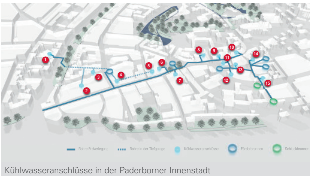
Kühlwasseranschlüsse in der Paderborner Innenstadt
